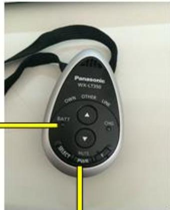
电源开关键（长按3秒开关机话筒）
